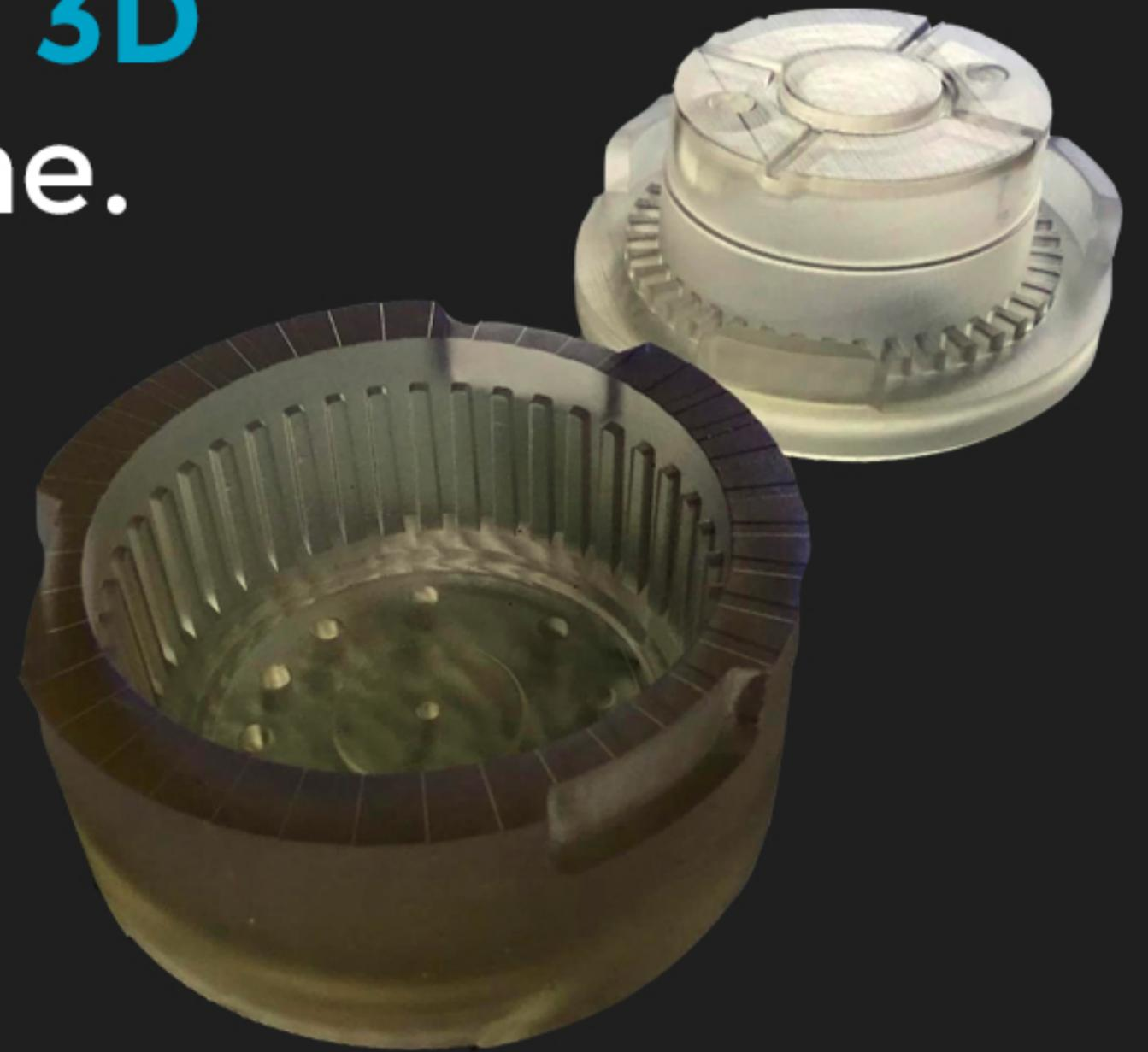
O molde é produzido a partir da impressão 3D quando o resultado esperado da combinação é uma peça feita em silicone ou algum tipo de material flexível.
