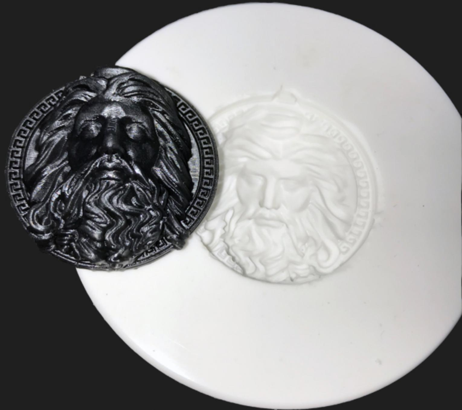
A partir da peça impressa fabricamos o molde de silicone, que por sua vez utilizamos para replicar a peça original em outros materiais como: resina, parafina, gesso, e outros.
